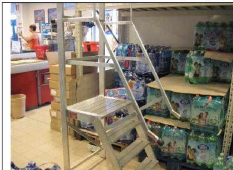
Fig. 33 – idonea (conforme alla UNI EN 131) scala a palchetto (in alluminio) per spostare i pacchi di acqua/bibite o cartoni sul ripiano più alto
