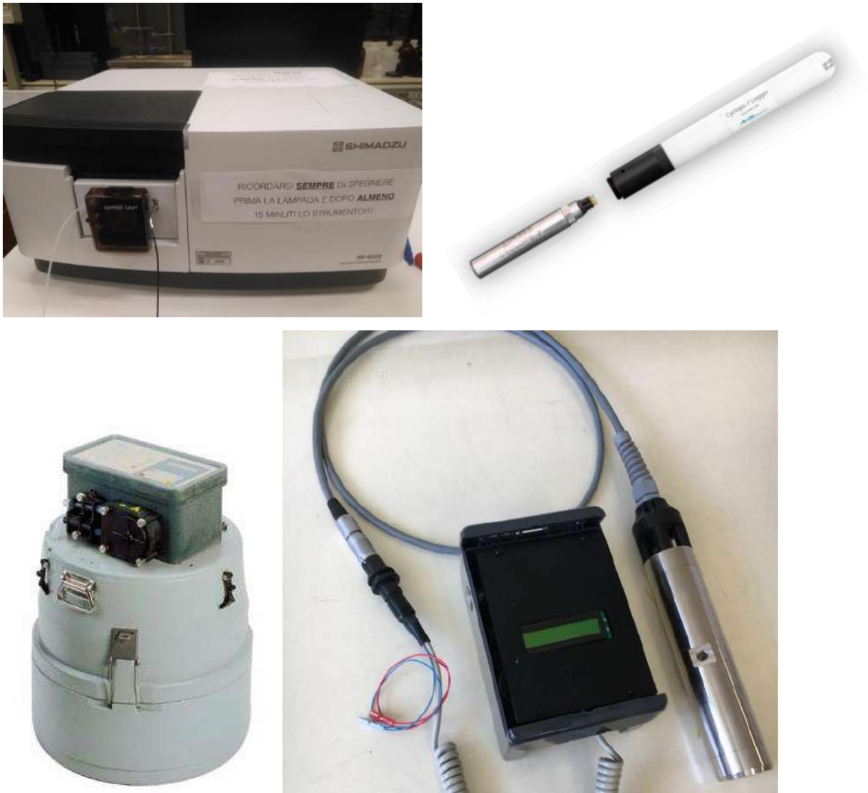
Figura 4.8 Strumenti utilizzati durante la prova: spettrofluorimetro di precisione, sonda PME, fluorimetro Albillia, autocampionatore ISCO.
