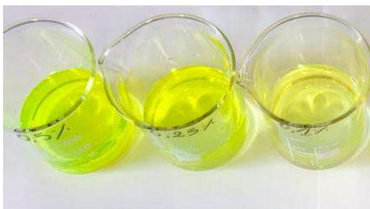
Figura 4.5 Fluoresceina usata per la prova di tracciamento.
