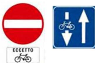
Figura 393 Segnaletica verticale per strade in cui non è possibile tracciare la linea discontinua di separazione dei due sensi di marcia
