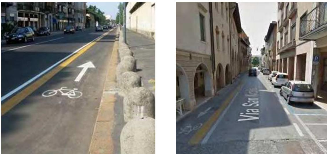
Figura 401 Esempi di pista ciclabile su corsia riservata
