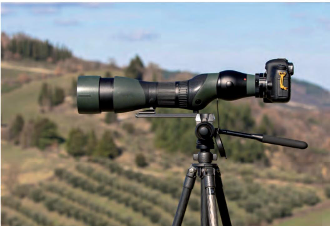
**Figura 4 - Reflex montata su telescopio terrestre tramite adattatore per *digiscoping***
