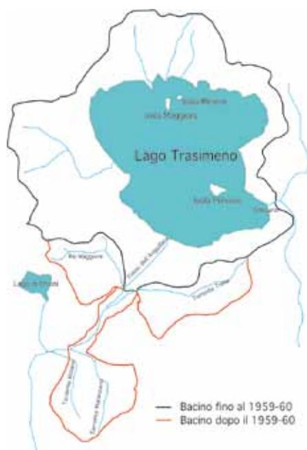
Fig. 10.1 Bacino imbrifero del Lago Trasimeno dopo l'ampliamento artificiale.
