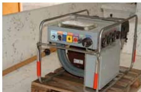
Fig. 13.2 - Generatore di corrente.
