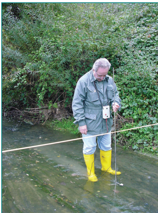
Misurazione di portata con mulinello idrometrico
