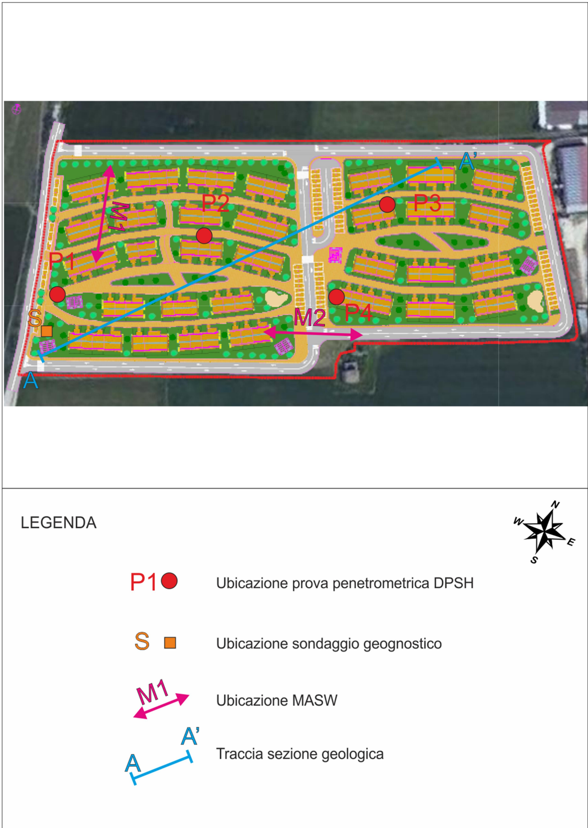
Fig.4 – Pianta progetto con ubicazione indagini – scala 1:2.000
