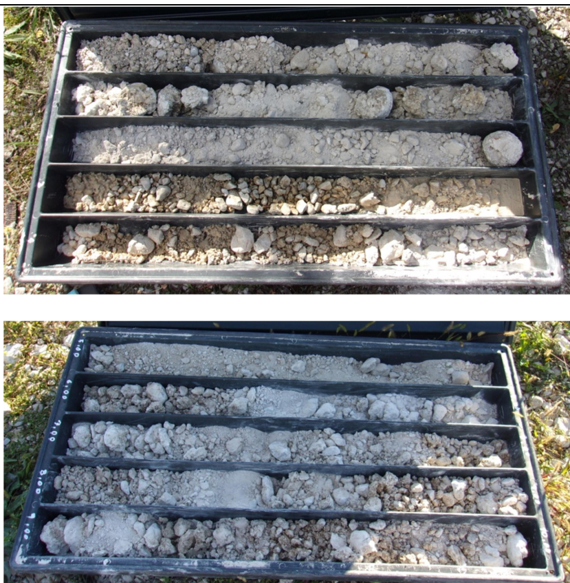
Foto 4 - 5 – Cassette sondaggio S1 (0-10 m)
